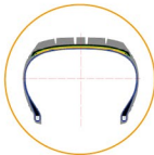
优化胎肩花纹沟底轮廓设计 提高散热性和耐久性能
